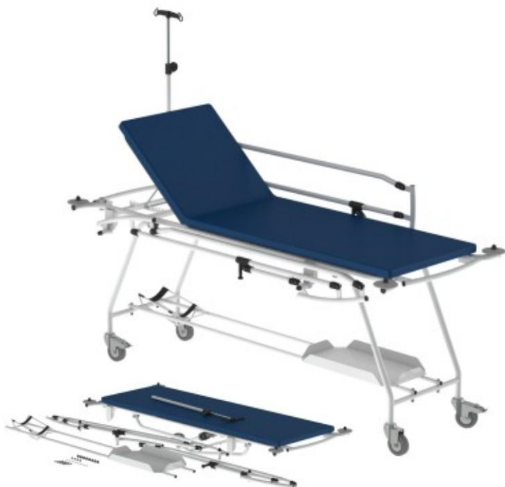
Estrutura em tubo de aço macio. Pintura Epoxy. Leito em resina fenólica. Colchão em espuma de alta densidade revestido a tela bi-elástica. Ajuste da cabeceira por sistema de cremalheira. Guardas laterais rebatíveis. Contém haste de soro ajustável em altura, suporte para garrafas de oxigênio e tabuleiro para roupa. Rodas batentes de proteção.
