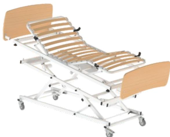
Estrutura em tubo de aço macio. Pintura epoxy. Estrado articulado em réguas de faia, tripartido, acionado por motor elétrico. Sistema elevador com quatro rodas, duas com travão. Sistema elevador com trendelenburg acionado por dois motores elétricos.
