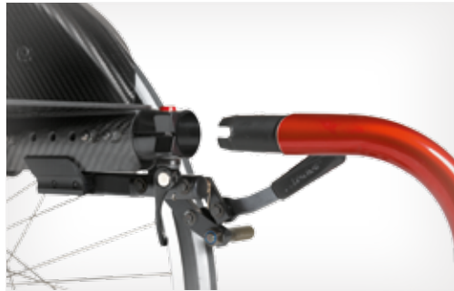
Opção de extração rápida para remover ou alterar o chassis dianteiro incluindo as rodas dianteiras
